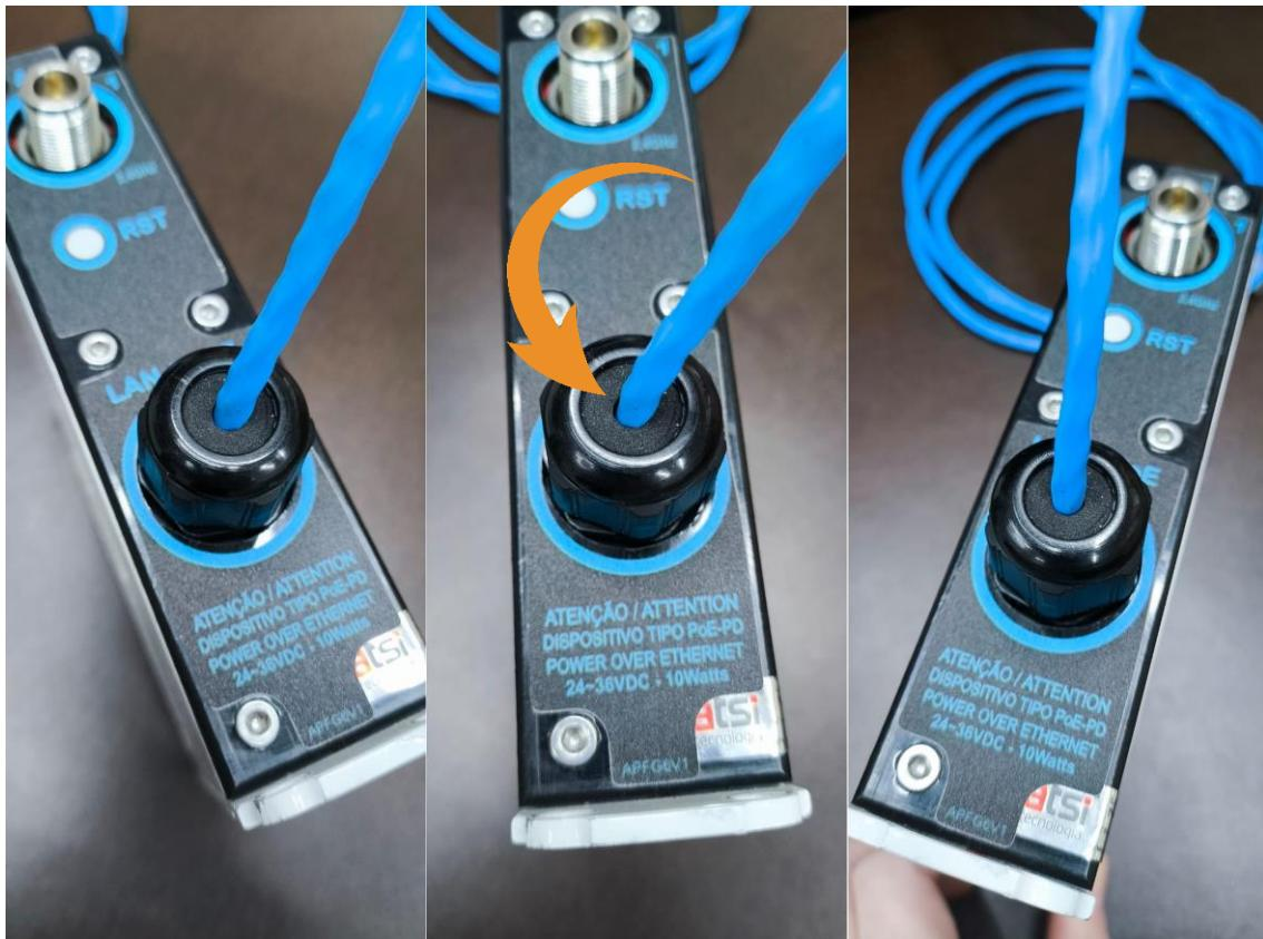
No caso do seu cabo ser mais fino, substitua o Cabo de Dados por um mais largo (padrão) ou faça um preenchimento (com fita isolante) para deixar o cabo fino mais largo sem comprometer a vedação do equipamento:
