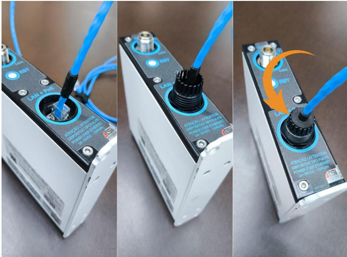
Após o procedimento anterior, aperte a tampa do Prensa Cabo e verifique se a bucha de vedação preencheu toda a volta do cabo de dados, eliminando frestas, proporcionando a correta vedação do equipamento.
