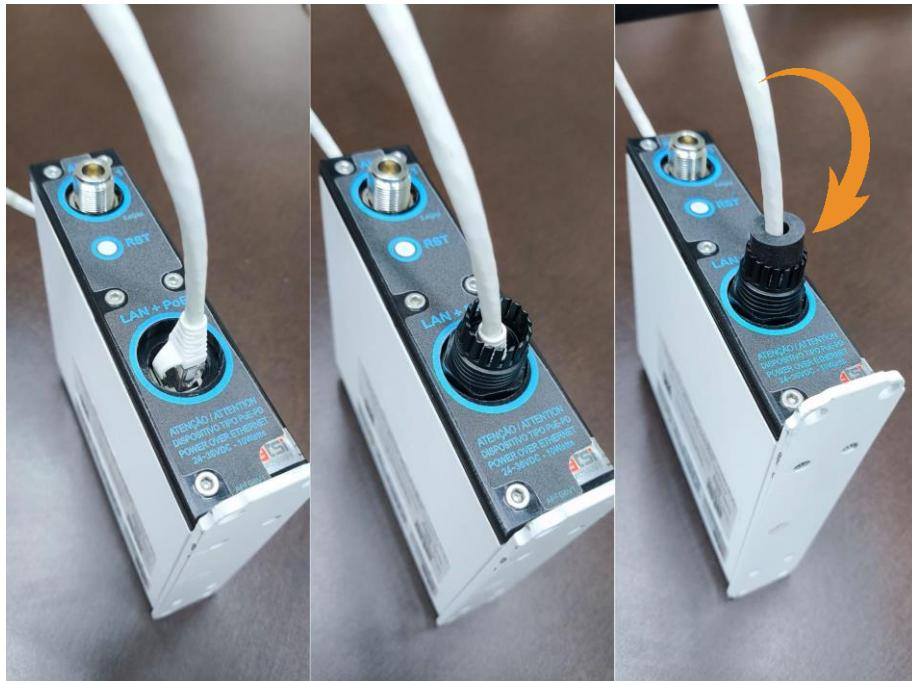
Utilize um cabo de dados **que não contenha Capa Cover** no conector RJ45 **ou RETIRE O CAPA COVER** do cabo de dados caso o cabo utilizado já contenha o Capa Cover, assim a bucha de vedação do Prensa Cabo ficará devidamente no lugar, proporcionando a perfeita vedação do equipamento.
